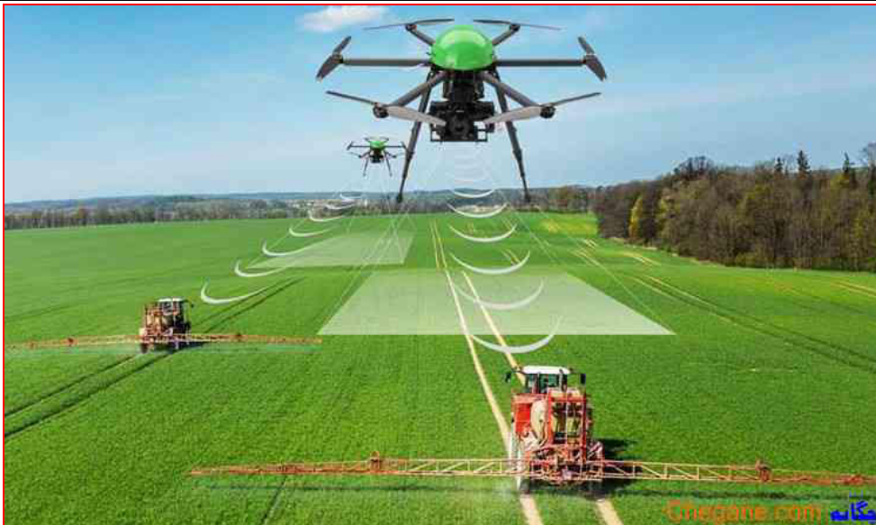
شکل ۱۲- هدایت ماشین‌ها در مزرعه بدون استفاده از راننده و به کمک ناوبری خودکار مجهز به سامانه موقعیت‌یاب جهانی (GPS)
