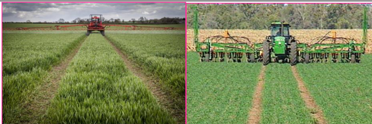
شکل ۶- استفاده از روش رفت و آمد در راهروهای ثابت برای انجام عملیات داشت (حرکت چرخ تراکتور در مسیر تردد ماشین‌های قبلی)
