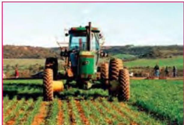
شکل ۱۴- افزایش طول اکسل تراکتور با قرار دادن قطعات رابط برای ایجاد امکان حرکت چرخ تراکتور از راهروهای ثابت
