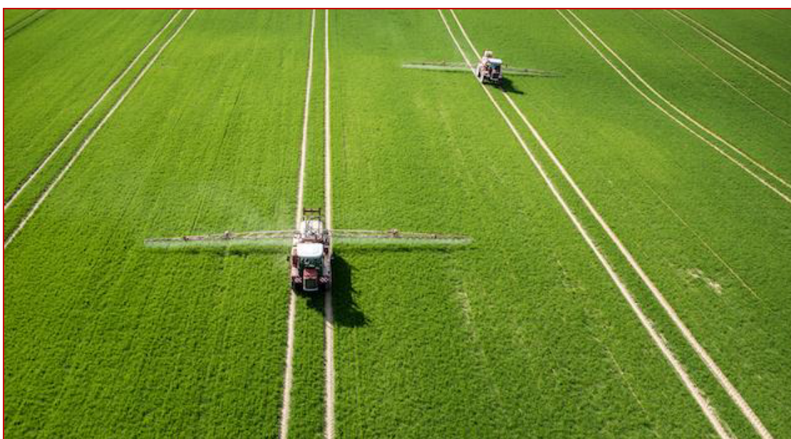
شکل ۵- استفاده از روش رفت و آمد در راهروهای ثابت برای انجام عملیات داشت (حرکت چرخ تراکتور در مسیر تردد ماشین‌های مورد استفاده در عملیات قبلی)
