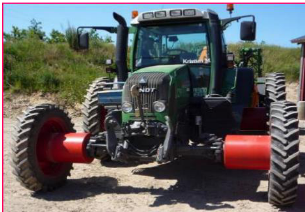
شکل ۱۴- افزایش طول اکسل تراکتور با قرار دادن قطعات رابط برای ایجاد امکان حرکت چرخ تراکتور از راهروهای ثابت
