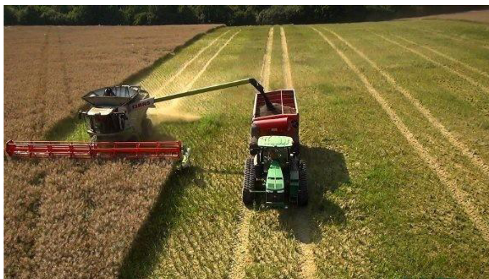
شکل ۱۳- حرکت چرخ تراکتور و تریلر حمل دانه در مسیر چرخ کمباین در مزرعه در روش استفاده از راهروهای ثابت
