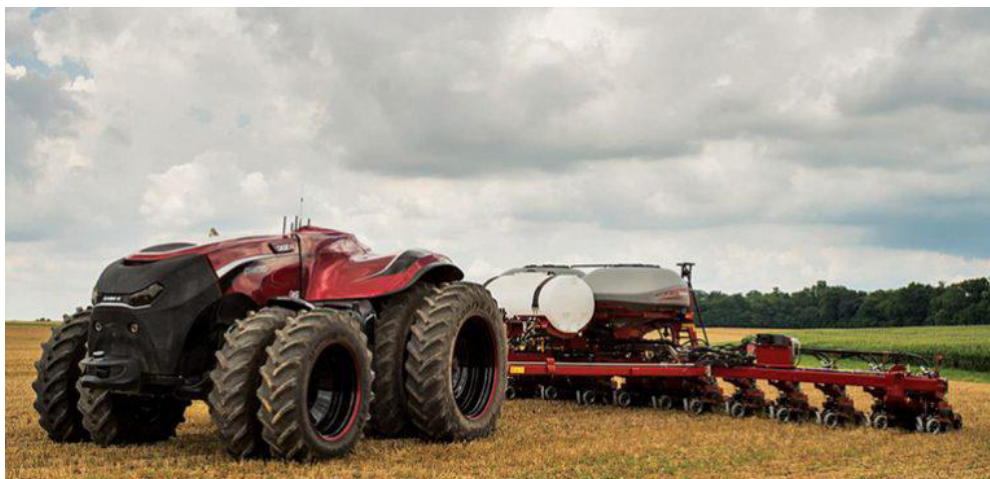
شکل ۱۱- هدایت ماشین‌ها در مزرعه بدون استفاده از راننده و به کمک ناوبری خودکار مجهز به سامانه موقعیت‌یاب جهانی (GPS)
