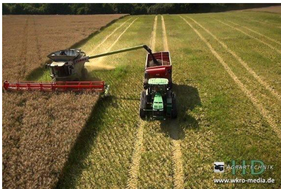
شکل ۷- استفاده از روش رفت و آمد در راهروهای ثابت برای انجام عملیات برداشت (حرکت چرخ تراکتور و ترکیب حمل دانه در مسیر تردد کمباین در مزرعه)
