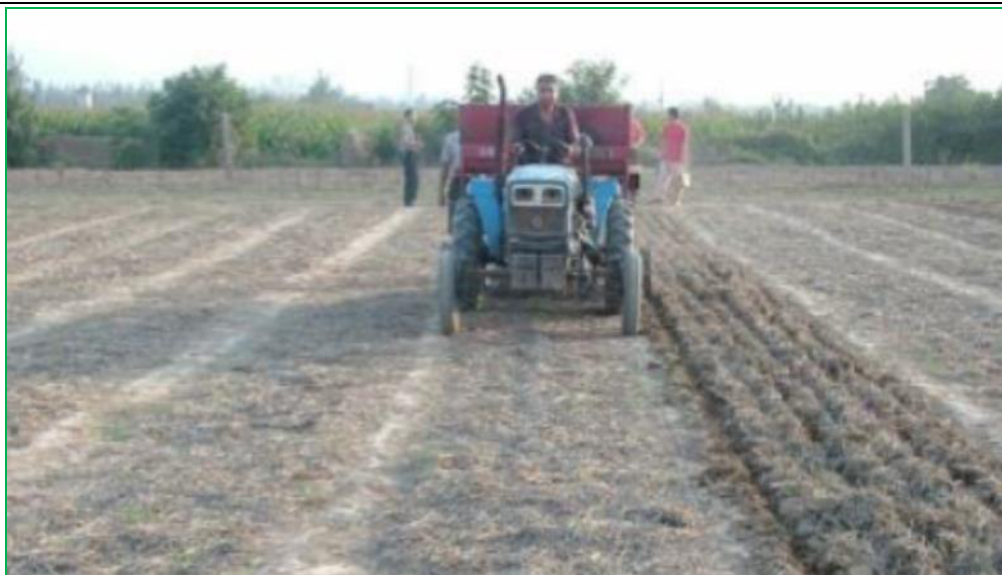
شکل ۴- استفاده از روش رفت و آمد در راهروهای ثابت برای انجام عملیات خاک‌ورزی و کاشت محصول جدید (حرکت چرخ تراکتور در مسیر چرخ کمباین محصول قبل)
